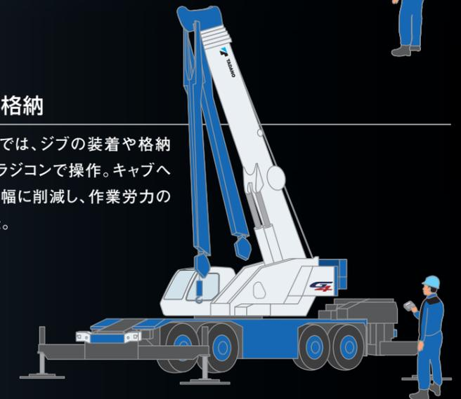
※セットアップラジコンでのクレーン操作は、アルミ敷板の設置・格納、アウトリガの張出・格納、ジブの装着・格納のみに使用してください。クレーン作業には使用できません。
