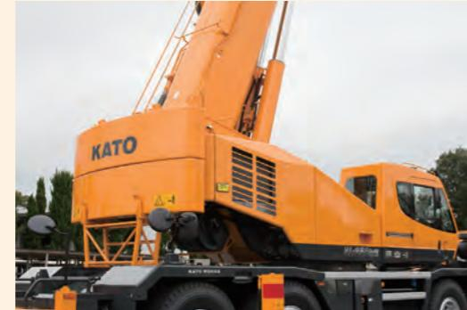
■ 2分割構造なのでクレーン付きトラックで積載運搬可能
